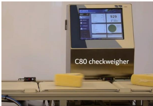
Teltek C80 Instalación en línea de producción de quesos.
