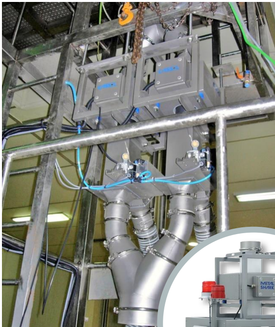
METAL SHARK® GF Instalación con doble tubería para caudales elevados.
